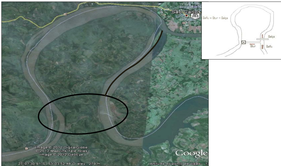
Fig. 02: trecho do rio Uruguai onde, com a instalação da barragem formou-se a Alça de Vazão Reduzida (AVR) ou alça seca que recebe apenas a vazão “ecológica” liberada pelas comportas da Usina. Na parte superior direita da imagem, a cidade de São Carlos e logo abaixo a confluência do Rio Chapecó com o rio Uruguai; o polígono sinaliza a localização aproximada do barramento; a linha destacada no leito do rio indica o trecho crítico de vazão reduzida, localizado entre o barramento e a confluência do rio Chapecó com o rio Uruguai. No detalhe, dinâmica de escoamento das vazões de uma AVR: Q flu – vazão de fluxo, Q tur – vazão turbinada, Q alça – vazão da Alça de Vazão Reduzida; o quadrado mostra a localização aproximada da Casa de Força. Fonte: Google Earth, acesso em 24/09/2012; ilustração da AVR: Cruz et al. (2010).
